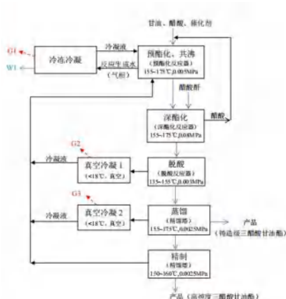
图 3.5-1 胶粘剂生产工艺流程
