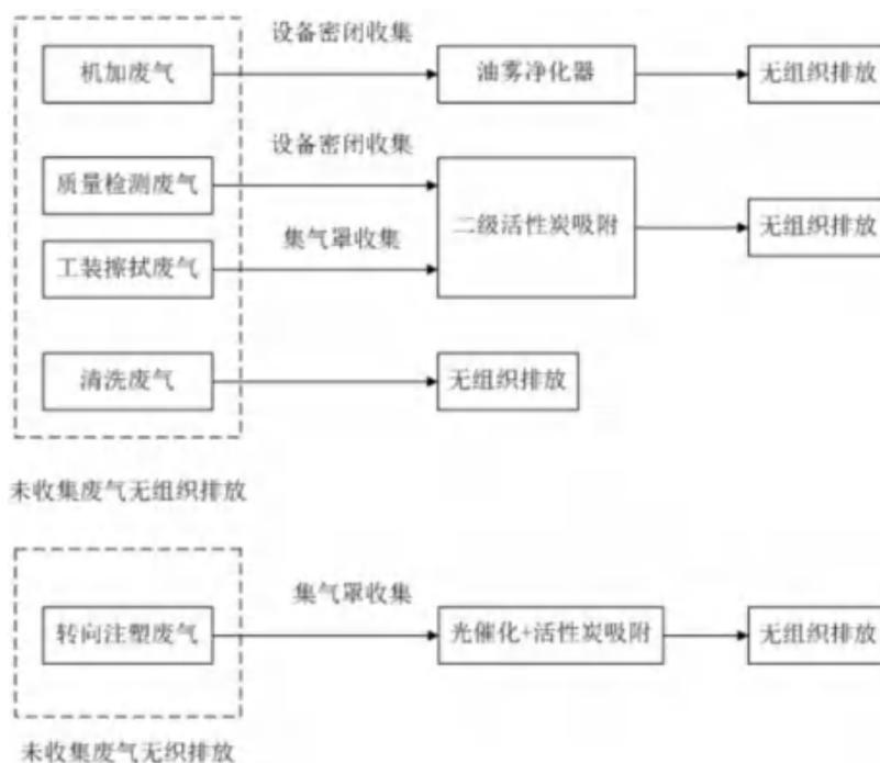
图4.1-3 废气收集气路示意图
